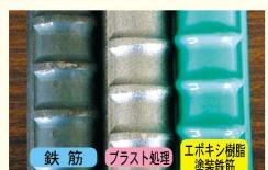
【塗装行程】 鉄筋→プラスト処理→エポキシ樹脂塗装
